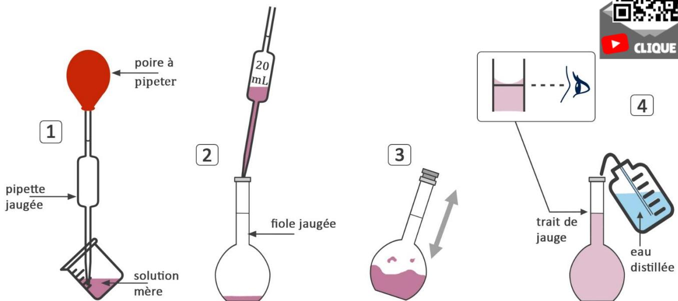
**Etape 1 :** Introduire la solution mère dans un bécher. Prélever cette solution à l'aide d'une pipette jaugée (d'un volume adapté), préalablement rincée.
