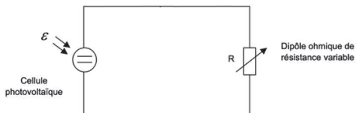
Le dipôle ohmique mis à disposition permet de régler des valeurs de résistance allant de 0 à 10 k $\Omega$ .
