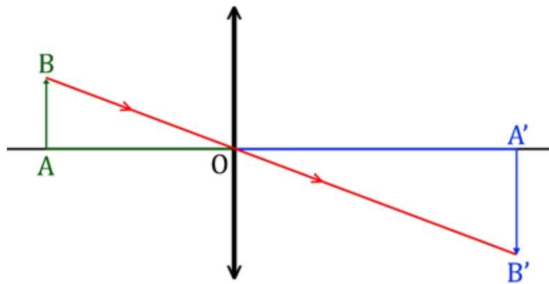
Surligner avec la même couleur les segments correspondants aux triangles semblables sur le schéma de la lentille et le triangle que le surplombe.
