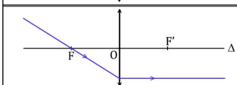
**Les rayons passant par le foyer objet F émergent de la lentille parallèlement à**
