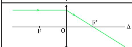
**Les rayons parallèles à l'axe optique émergent de la lentille en passant par le**
