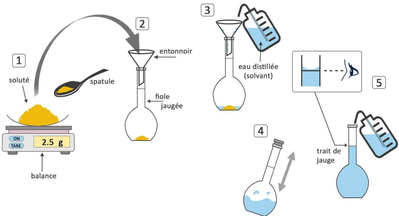
**Etape 1 :** Placer une coupelle ou un verre de montre sur le plateau d'une balance électronique et effectuer la tare (mise à zéro). Peser précisément la masse en prélevant le soluté avec une spatule propre et sèche.
